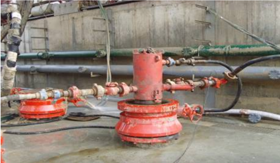
图 2 表层批量固井井口连接
